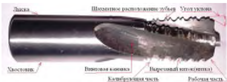
Рис. 5 – Альтернативное исполнение метчика \frac{1}{2} ".
