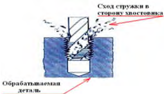
Рисунок 4 – Отвод стружки по спиральным канавкам [4].
