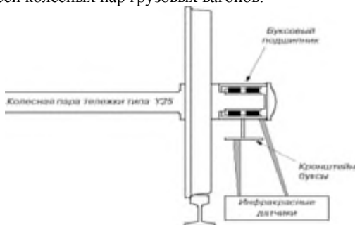
Рис. 2 - Схема размещения измерительного оборудования
