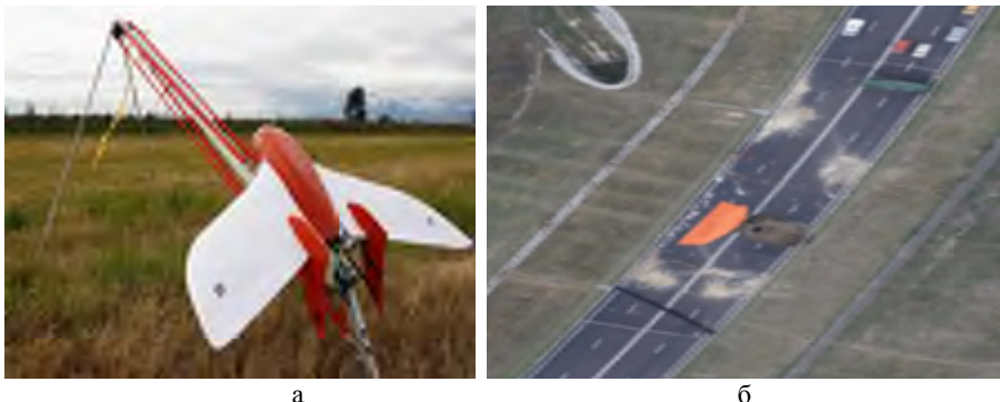
Рис. 1 - Применение БПЛА при обследовании участка ДТП и введении ограничений скоростного режима на месте провала на автомобильной дороге Республики Крым
