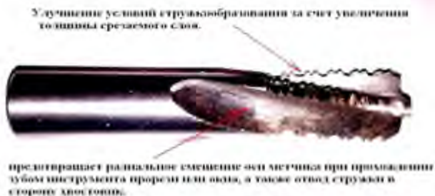
Рис. 8 – Метчик \frac{1}{2} " с измененной геометрией
